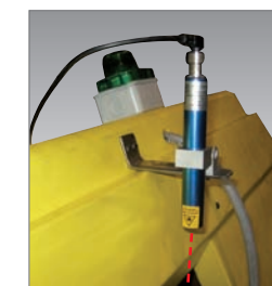
LX Illuminazione linea di taglio con laser Laser lighting for cutting line Projection de la ligne coupe par laser
