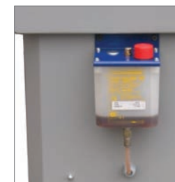
NB1 Nebulizzatore per la lubrificazione lama Sprayer for blade lubrication Micro pulverisation du ruban
