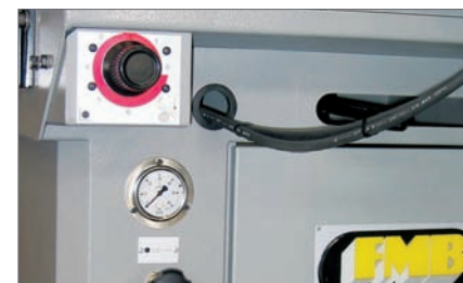
RPM1 Regolazione pressione morsa Vice pressure adjustment Reglage de la pression de serrage de l'etau
