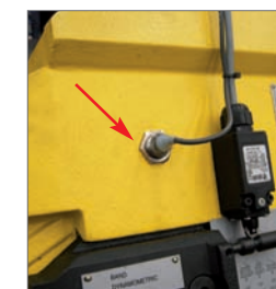
SENS Sensore rotazione nastro Blade rotation sensor Contrôle de defilement du ruban par detecteur
