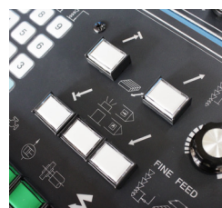
Règlage auto des butées transversales depuis le pupitre de commande
