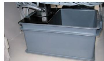
Vasca refrigerante di 20 l posizionata all'interno del basamento in una posizione facilmente asportabile per la pulizia e il riempimento.
