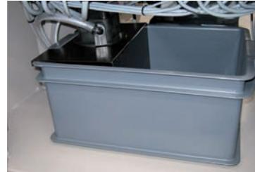
Vasca refrigerante di 20 l posizionata all'interno del basamento in una posizione facilmente asportabile per la pulizia e il riempimento.
