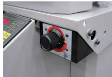
Sistema di movimentazione arco con cilindro idraulico e valvola bilanciata per regolazione discesa in posizione frontale.
