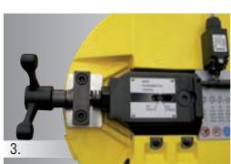
La tensione del nastro è aggiustabile; un sistema dinamometrico è in grado di segnalare in modo immediato e visivo il raggiungimento del valore di tensione corretto per il nastro, e un finecorsa interrompe la rotazione dei volani in caso di rottura del nastro.
