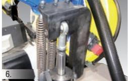
Attacco cilindro oleodinamico arco con snodo sferico per un lineare avanzamento della discesa dell'arco.
