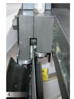
Il corpo guida lama è combinato: cuscinetti verticali sfalsati per un primo raddrizzamento, placchette in metallo duro (19x19 mm) di contenimento regolabili e un cuscinetto con dimensioni adeguate posto sul dorso della lama a contrasto dello sforzo di taglio (la rotazione di un cuscinetto di contrasto aumenta considerevolmente la durata della lama rispetto ad un contrasto strisciante). Queste caratteristiche permettono un'elevata precisione verticale nel taglio.
