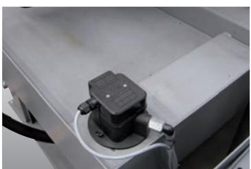
Vasca refrigerante di 40 litri integrata nella parte superiore del basamento con foro di scarico.
