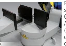
Piano appoggio materiale continuo con settore scaricato per passaggio lama. Ganasce riportate e sostituibili. Avvicinamento della slitta con vite trapezoidale (non per Galactic+VHZ) e bloccaggio rapido del materiale a leva/idraulico per ripetizione di tagli multipli. Accoppiamento slitta morsa prismatica di precisione. Ganascia d'appoggio materiale in uscita.
