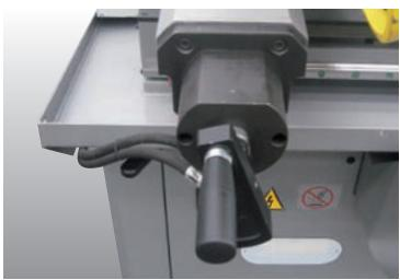
Morsa chiusura materiale in ghisa a posizionamento manuale, dotata di cilindro di chiusura idraulico.
