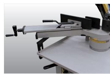
Gruppo morsa: avvicinamento della slitta tramite vite trapezoidale; bloccaggio rapido del materiale con leva per ripetizione di tagli multipli. Posizione inclinata rispetto al basamento della macchina in modo da permettere tagli inclinati sia a destra che a sinistra senza interferenze con la lama e senza la necessità di dover essere posizionata a destra o sinistra in funzione del tipo di taglio.
