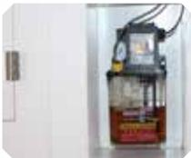
Graissage des glissières par injection multipoint permettant un travail sec
