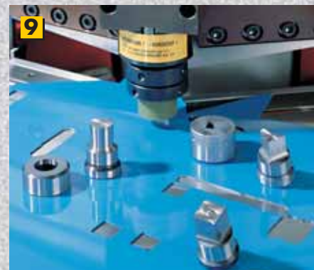
9 SET UTENSILI DI PUNZONATURA PUNCHING TOOL SET JEU OUTILS DE POINÇONNAGE SATZ LOCHSTANZWERKZEUG JUEGO DE HERRAMIENTAS DE PUNZONADO
