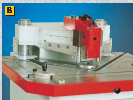
B Testa stozzatrice. Slotting head. Tête à rainier. Stoskopf. Cabezal de repujado.
