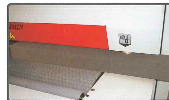
Automatic measuring of workpiece thickness Automatische Abmessung der Werkstück dicke Automatické měření tloušťky dílce Automatyczny pomiar grubości elementu Автоматическое измерение толщины материала
