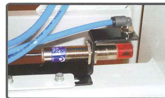
Sensor of the belt oscillation Der Sensor Sensor oscilace brusného pásu Fotokomórka z promieniowaniem podczerwonym Сенсор осцилации
