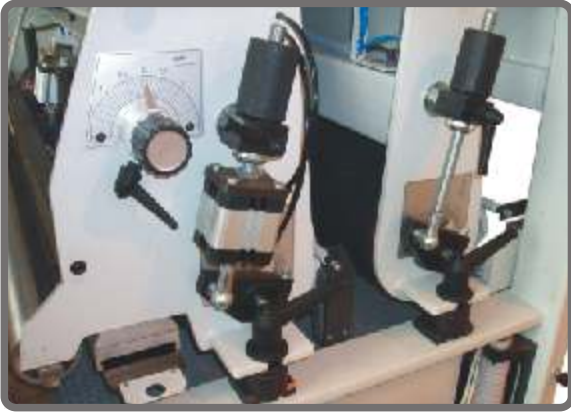
Pneumatic control height of the roller Pneumatische Zusprung und Absprung der Kontaktwalze Pneumatické zvedání brousících válců Pneumatyczne sterowanie wysokości wałów Пневматическое управление высоты шлиф. валов
