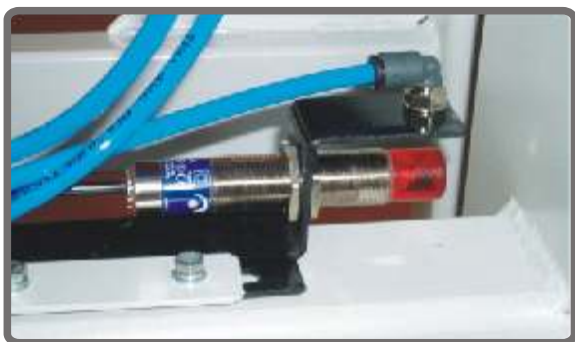
Sensor of the belt oscillation Der Sensor Senzor oscilace brusného pásu Fotokomórka z promieniowaniem podczerwonym Сенсор осцилации
