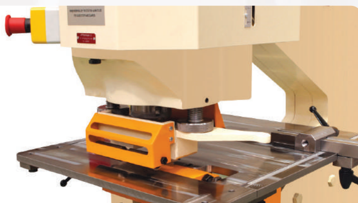
Une table de poinçonnage avec butées millimétrées
