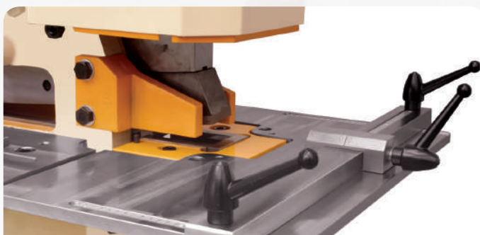
Une table grugeoir avec butées millimétrées
