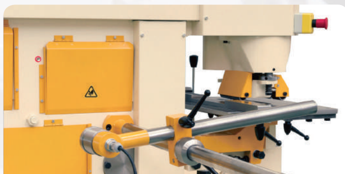
Une butée électrique d'un mètre
