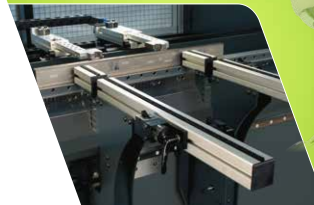
Bras mobiles et réglables dans la hauteur
