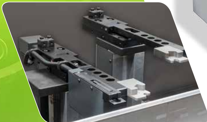
Butée arrière 3D (X1-X2, Z1-Z2, R1-R2)
