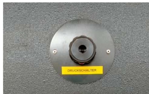
Dans la version automatique des presses, il permet au **vérin hydraulique de monter automatiquement** lorsque la pression d'étalonnage est atteinte.
