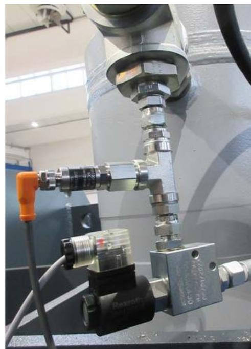
Essentiellement, cet accessoire **protège le circuit hydraulique** de la presse et est particulièrement recommandé lorsque l'on travaille à haute pression.
