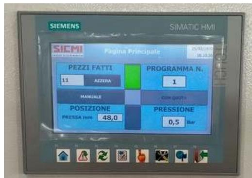
Sur demande, il est possible d'installer l'écran tactile **Siemens KTP 700 Basic**, qui permet de **régl**er les paramètres suivants :
