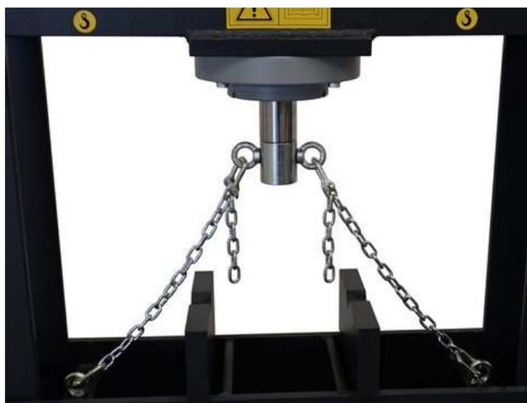
Le **levage de la plateforme** de travail s'effectue au moyen d'une **chaîne** reliée au vérin hydraulique.
