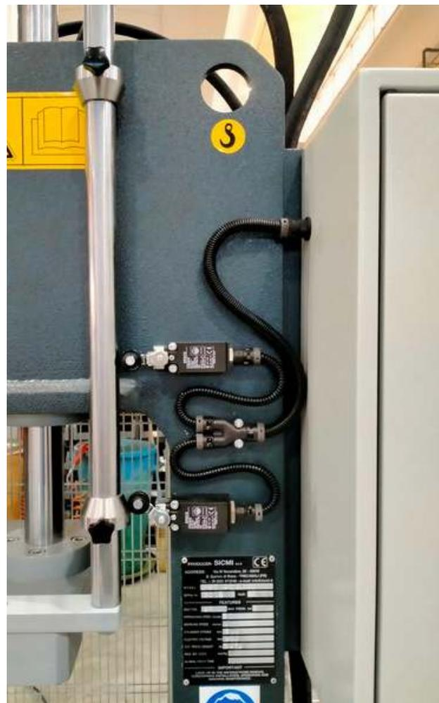
Ce signal peut être utilisé pour **arrêter le mouvement du cylindre** ou, dans la version automatique (*non disponible pour les modèles PSS et PSS-NC*), il peut également être configuré pour **activer automatiquement le retour du cylindre** à sa position d'origine.
