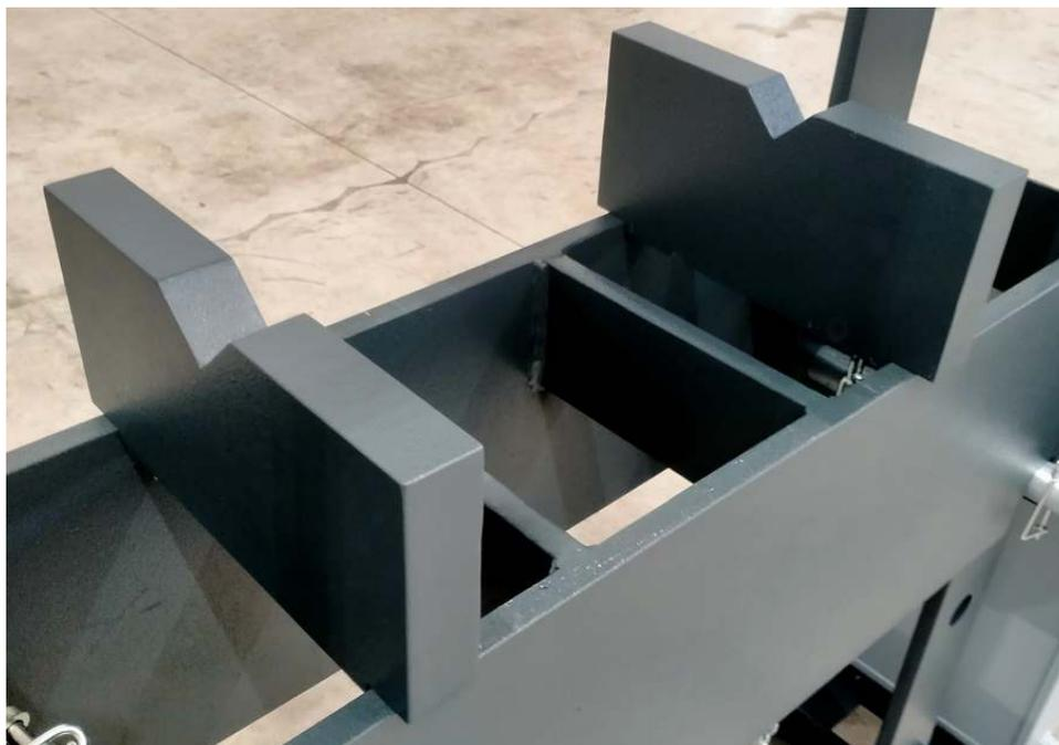
La paire de prismes en V a pour fonction de **soutenir la pièce métallique** à usiner et est fixée au plan de travail de la presse hydraulique.
