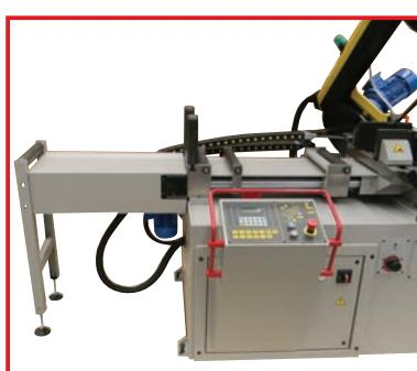
La macchina viene fornita con una rulliera, in lato carico, lunga 700 mm per la versione standard e 1200 mm per la corsa C1000.
