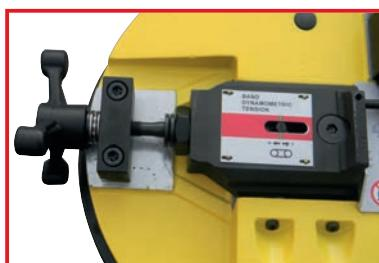
La lama è tensionabile manualmente. Un sistema dinamometrico segnala la giusta tensione della lama. Il raggiungimento della tensione corretta è chiaramente visibile da una tacca, in caso di rottura della lama, un fincorsa ne interrompe la rotazione.
