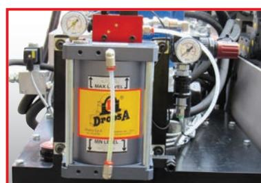
La macchina è dotata di un sistema di lubro-refrigerazione (NB1 Box). Piccole quantità di lubrificante proiettate in un flusso di aria a bassa pressione raffreddano e lubrificano la lama durante il taglio.
