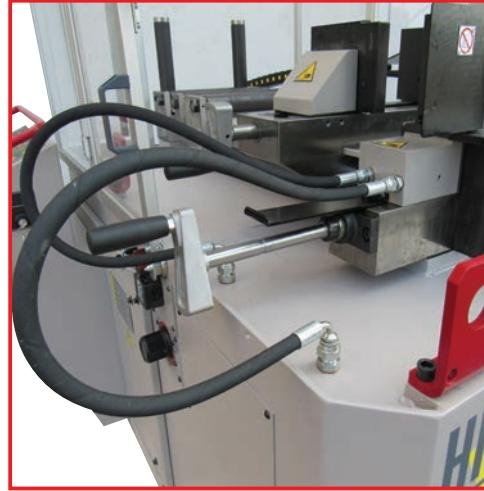
Morsa chiusura materiale in ghisa a posizionamento manuale, dotata di cilindro di chiusura idraulico.
