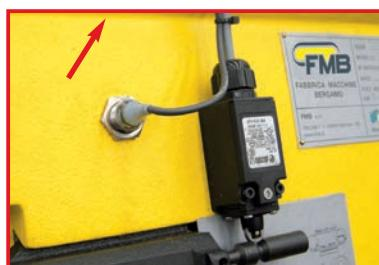
Sensore elettrico (SENS) per il controllo della rotazione del volano folle. In caso di sforzo eccessivo di taglio o se la lama non è correttamente tesa, interviene il SENS che ferma la rotazione della lama impedendo che si spezzi.
