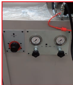
RPM2 Regolazione pressione morsa. Vice pressure adjustment. Reglage de la pression de serrage de l'etau.
