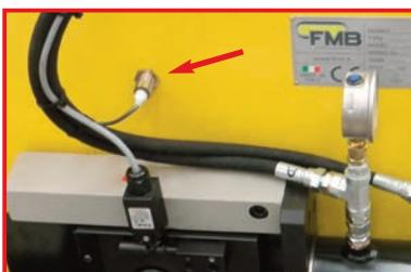
Sensore elettrico per il controllo della rotazione del volano folle. In caso di sforzo eccessivo di taglio o se la lama non è correttamente testesa, interviene l'optional SENS che ferma la rotazione della lama impedendo che si spezzi.
