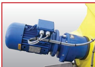
Riduttore ad ingranaggi a denti inclinati cementati rettificati e lubrificati con grasso a lunga durata. L'albero di ingresso è realizzato con acciaio legato, cementato e temprato; quello in uscita con acciaio bonificato. Rendimento del riduttore pari a 95% contro il rendimento pari a 55% di un riduttore a vite senza fine comunemente utilizzato su segatrici a nastro.
