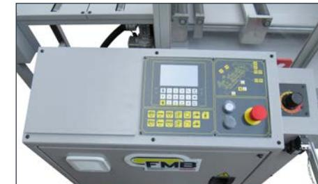
Panneau de contrôle avec clavier alphanumérique pour insérer les programmes et les paramètres de coupe.
