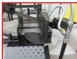
Piani della morsa taglio e carro dotati di spine temperate sostituibili in caso di usura. Avvicinamento della ganascia mobile tramite una vite trapezoidale che garantisce un sistema di manovra scorrevole ed efficiente anche ad elevati carichi. Accoppiamento slitta morsa prismatica per una maggior precisione. Ganasse sostituibili in caso di usura. Ganascia d'appoggio per il sostegno del materiale in uscita.
