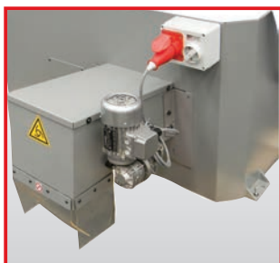
ST Scaricatore trucioli. Swarf extractor. Évacuateur de copeaux.
