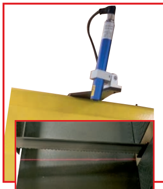
LX Illuminazione linea di taglio con laser. Laser lighting for cutting line. Projection de la ligne coupe par laser.
