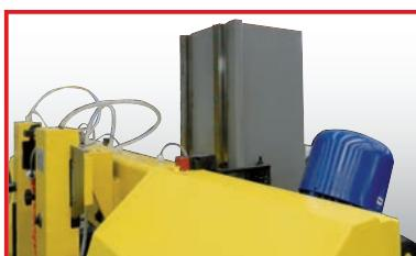
Discesa arco su colonna quadrata e doppia guida lineare. Colonna riempita con cemento per garantire stabilità ed assenza di vibrazioni durante il taglio.
