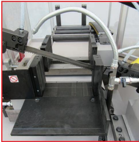
Avvicinamento della ganascia mobile tramite una vite trapezoidale che garantisce un sistema di manovra scorrevole ed efficiente anche ad elevati carichi. Accoppiamento slitta morsa prismatica per una maggior precisione. Ganasce sostituibili in caso di usura. Ganascia d'appoggio per il sostegno del materiale in uscita. Piani della morsa taglio e carro dotati di spine tempestate sostituibili in caso di usura.
