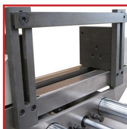
Il telaio di contenimento è indicato nei tagli " a fascio" perché mantiene allineate le barre, previene spostamenti accidentali del materiale e ne evita il sollevamento durante la movimentazione della morsa carro.
