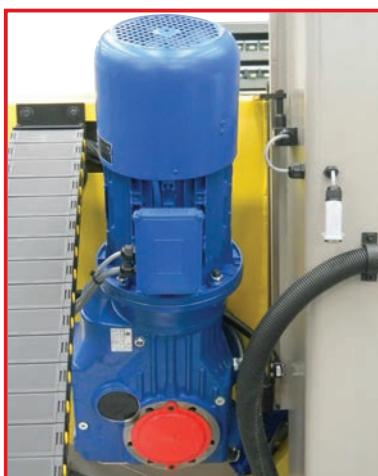
Riduttore ad ingranaggi a denti inclinati cementati rettificati e lubrificati con grasso a lunga durata. L'albero di ingresso è realizzato con acciaio legato, cementato e temprato; quello in uscita con acciaio bonificato. Rendimento del riduttore pari a 95% contro il rendimento pari a 55% di un riduttore a vite senza fine comunemente utilizzato su segatrici a nastro.
