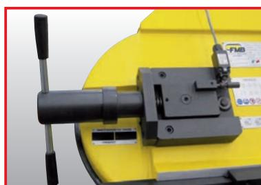
La tensione della lama è aggiustabile: un sistema dinamometrico è in grado di segnalare in modo immediato e visivo il raggiungimento del valore di tensione corretto per il nastro, e un finecorsa interrompe la rotazione dei volani in caso di rottura del nastro.
