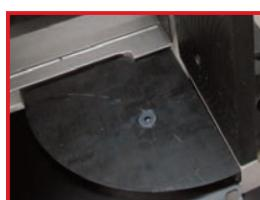
In dotazione alla macchina viene fornito un pianetto aggiuntivo smontabile per aumentare la superficie di appoggio del piano morsa. È utile per tagliare stabilmente pezzi di piccole dimensioni. Può essere usato solo nei tagli da 0° a 45°.
