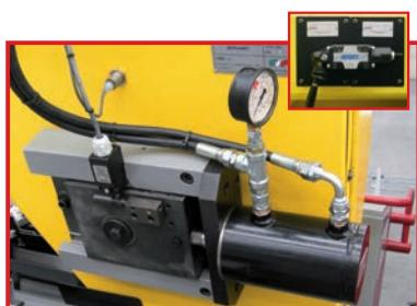
Il tenditore idraulico mantiene la lama correttamente tesa. A macchina spenta la lama viene allentata per evitare un inutile lavoro statico.
