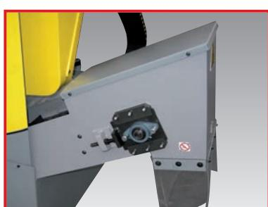
Lo scarico trucioli permette l'evacuazione del truciolo dall'interno all'esterno del basamento.
